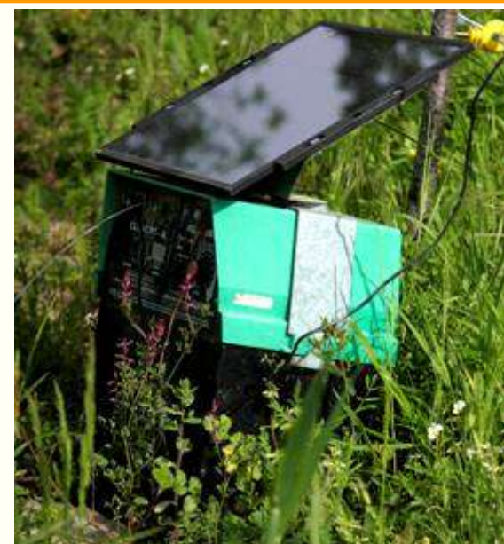
Alimentatore della recinzione elettrificata ricaricato da un pannello solare (per ridurre i tempi e costi della manutenzione)
